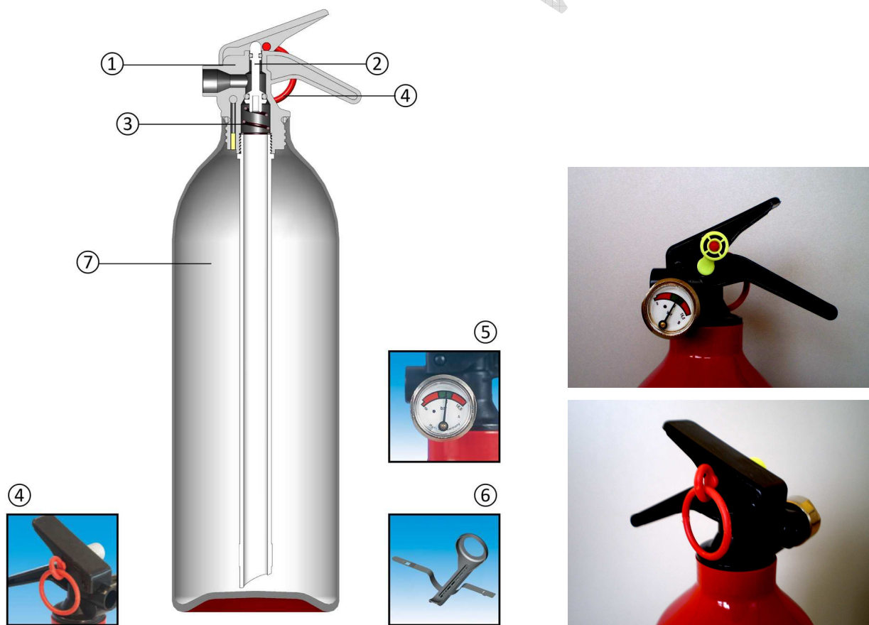
Detail hlavy hasičího přístroje s manometrem a plastovou pojistkou.
