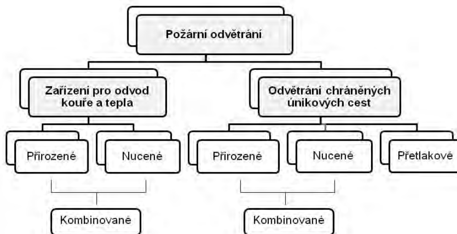
Obr. 1 – Rozdělení požárního odvětrání
