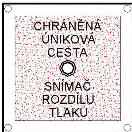
Obr. 8 - Doporučené označení snímače rozdílu tlaků
