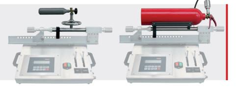
• Art.-Nr. 186103 Füllkopf F2 für außenliegende CO<sub>2</sub>-Flaschen mit Drehventil bis 300 g.
