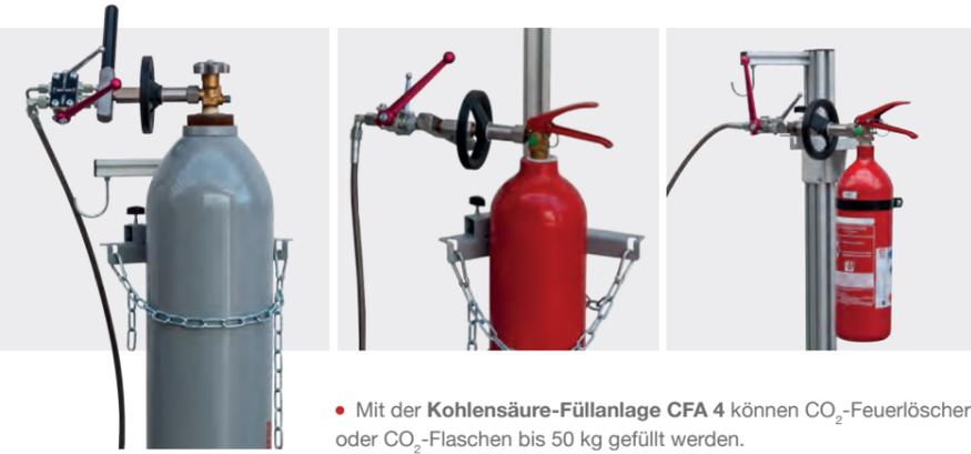
• Mit der Kohlensäure-Füllanlage CFA 4 können CO<sub>2</sub>-Feuerlöscher oder CO<sub>2</sub>-Flaschen bis 50 kg gefüllt werden.
