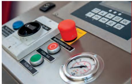
• Am frei platzierbaren und höhenverstellbaren Bedienpult der CFA 4 wird der Füllprozess programmiert und gesteuert.
